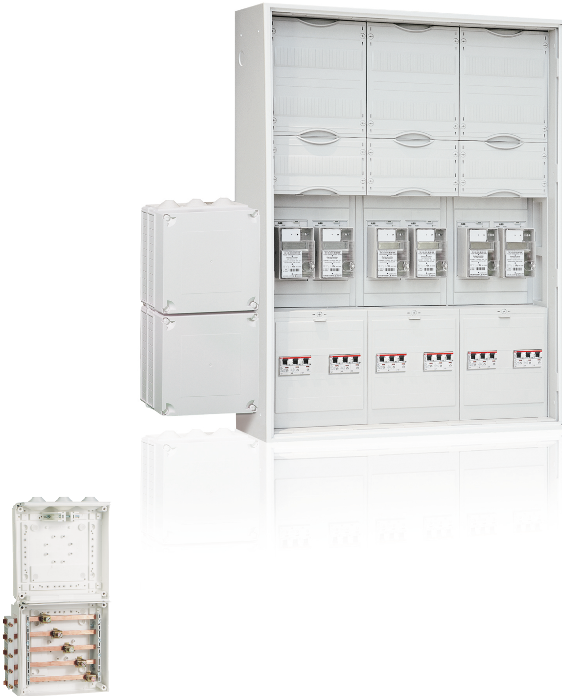
Einspeisegehäuse EK230 mit Sammelschienensystem Cu 12 x 5 mm, 5-polig zur seitlichen Einspeisung rechts oder links am Zählerschrank. (Sammelschienenanschlussklemmen Zubehör)
